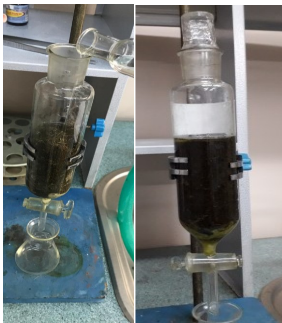
Рисунок 3 – Загруженное в перколятор сырье и экстрагент
